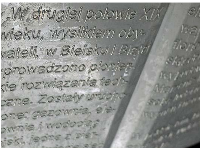
Tekst wypsawany przez robot TAWERS PANASONIC
